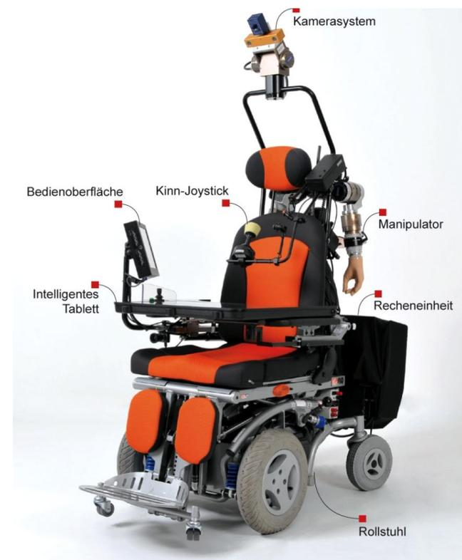
**Bild 1** Der Unterstützungsroboter FRIEND (Foto: Frank Pusch/IAT).
